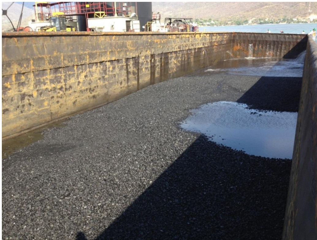
Figura 4-5 Carbón restante en la Barcaza 115 después del aligeramiento de emergencia
