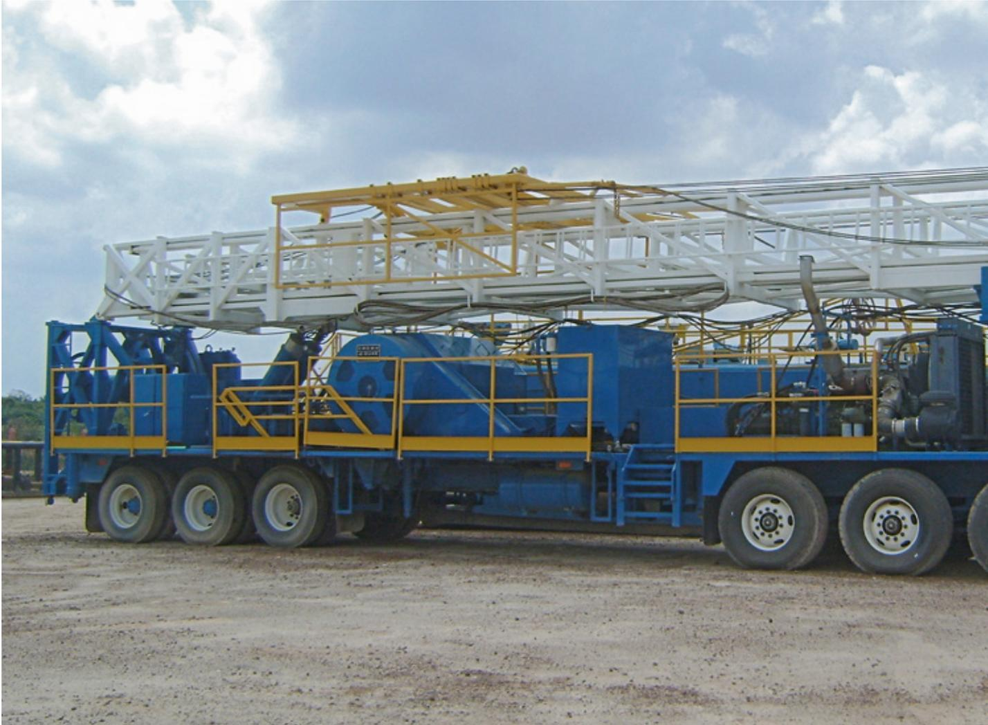
a través del subsuelo, que llega hasta los mantos de carbón que almacenan el gas. Este hueco se realiza utilizando un taladro especializado con brocas de alta resistencia y tubería de acero. Los mantos son estimulados con agua para establecer comunicación con el pozo, y posteriormente se complementan con la instalación de equipos de fondo de pozo y de superficie, que permiten poner cada pozo en producción.
