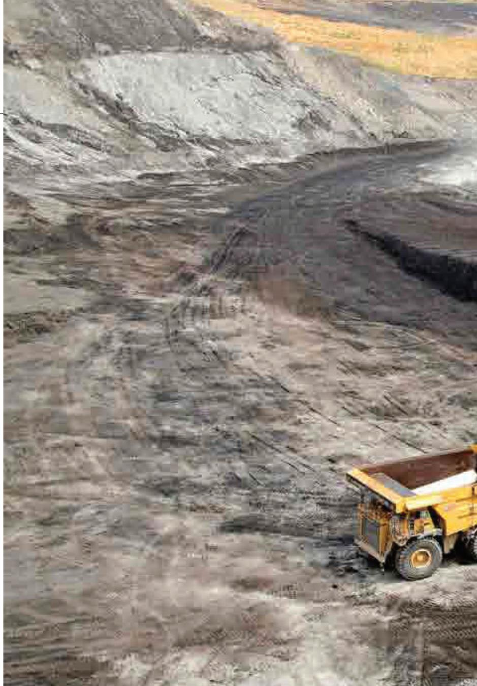
más a fondo, porque una vez se retira la capa superficial de suelo con tractores y buldózer hay que remover el material aluvial y la roca que cubre los mantos de carbón.
