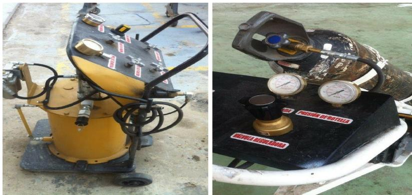
Del lado izquierdo se observa el calibrador de aceite, del lado derecho se observa el calibrador de nitrógeno.
