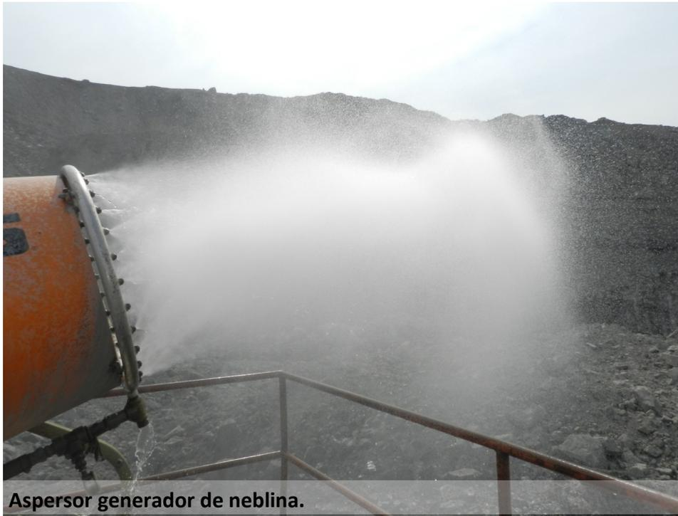
*\*Para controlar las emisiones de material particulado, Drummond cuenta con siete aspersores tipo turbina generadores de neblina, que trabajan desde el banco de avance de las palas, para evitar que las partículas de polvo se expandan con el movimiento de estos equipos mineros, mientras se realiza el cargue de camiones.*
