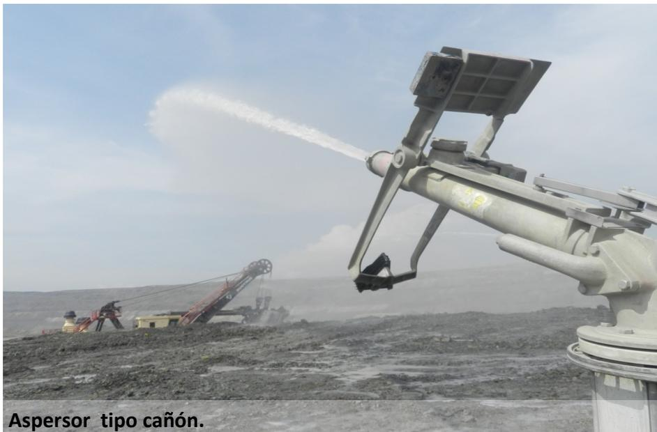
Otro de los aspersores utilizado en la operación es el de tipo cañón. Estos humectan el área de trabajo de las palas, minimizando las emisiones de material particulado en el momento del cargue del material.
