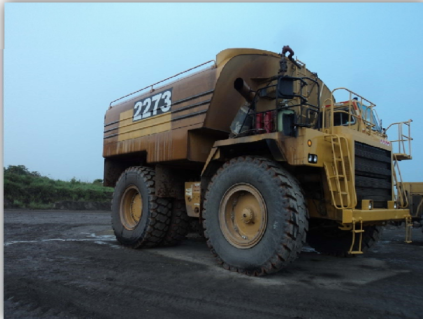
Foto 8. Tanquero de 22'000 galones empleado en el riego de vías.
