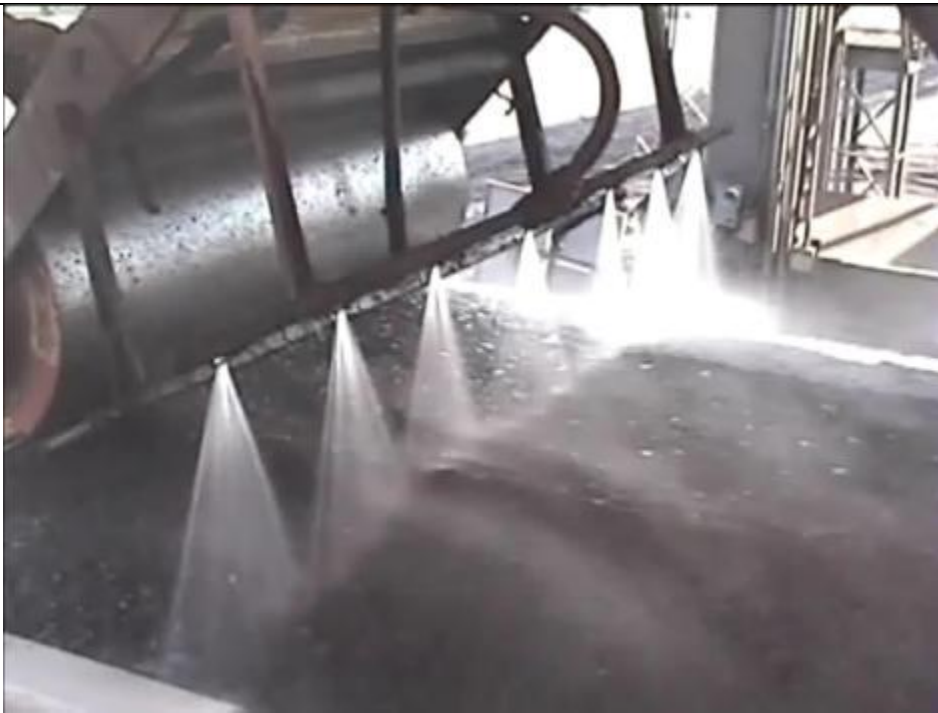
Foto 5. Compactación y humectación del carbón en los vagones del tren.
