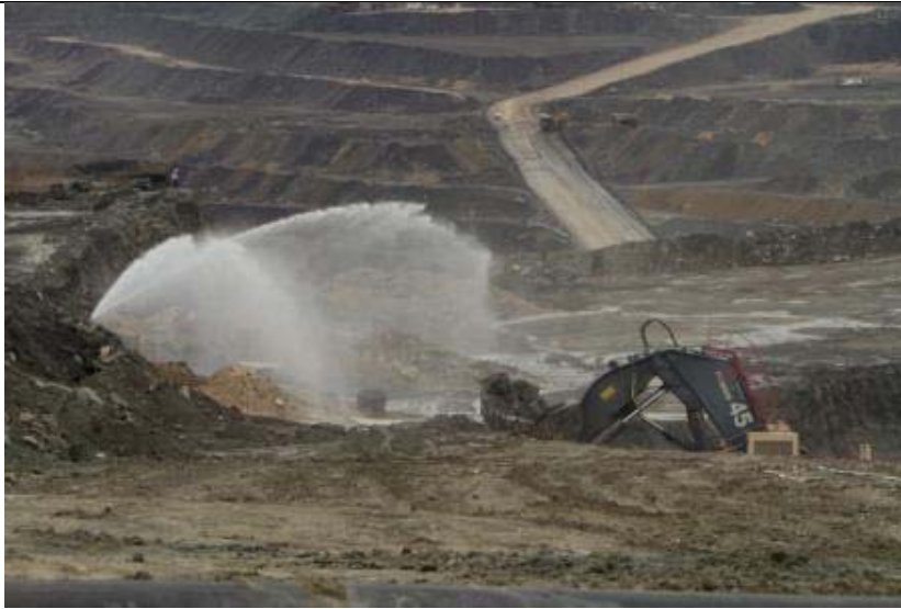
Foto 10. El control se ha complementado con cañones de agua que humectan el material que será cargado en las áreas de operación de las palas.
