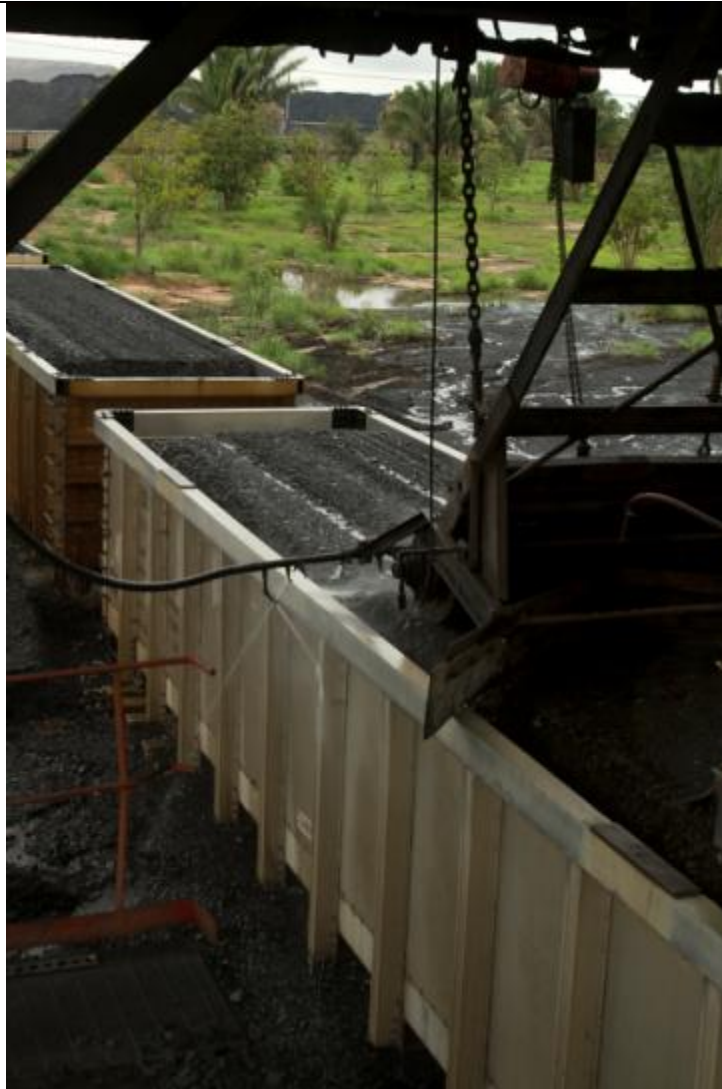
Foto 7. Compactación y nivel de carbón en la góndola que no sobresale del nivel superior de la misma.
